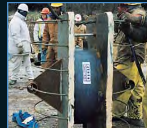
الاختبار الجانبي باستخدام أو - سل (O-cell) لتحديد معامل الانضغاط الجانبي للصخر
